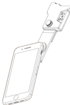
Posizionare l'obiettivo sul soggetto da osservare. Tieni DIPLE Lux in una mano, come una lente d'ingrandimento, e il telefono nell'altra. Con l'app della fotocamera attiva, sposta il telefono verso il centro dell'anello di gomma nera e appoggialo ad esso. Inclina leggermente DIPLE Lux o usa la vite di elevazione per trovare la giusta distanza di lavoro. Modifica l'intensità della luce con i pulsanti + e -.
